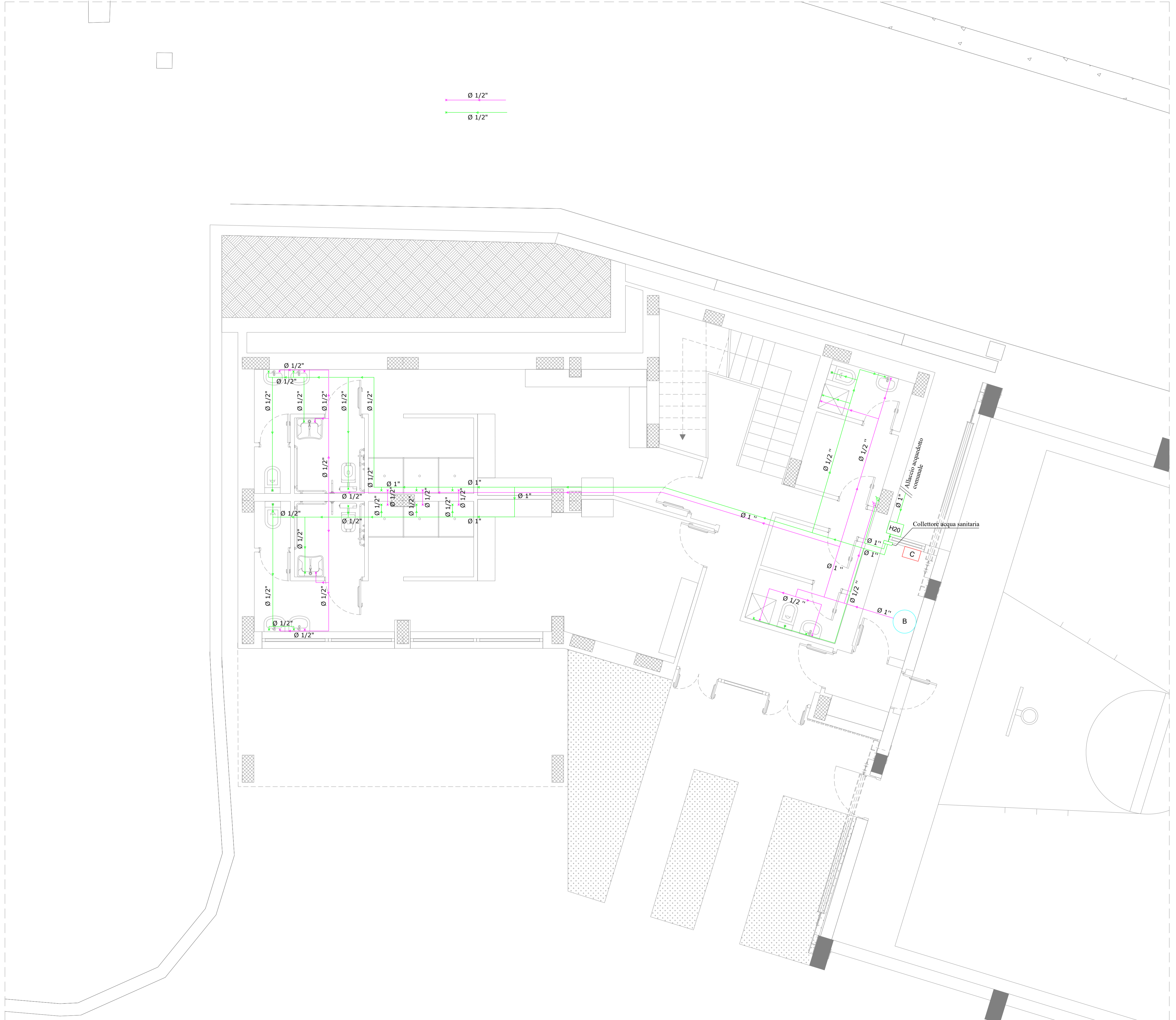
Pianta del piano terra - schemi linee di adduzione scala 1:50
